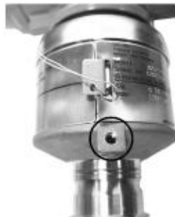
Внешний зажим заземления встраиваемого датчика SuperModule 3051S
