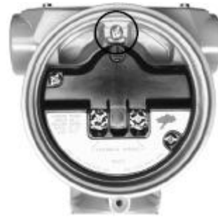
Подсоединение к внутреннему зажиму заземления 3051S
